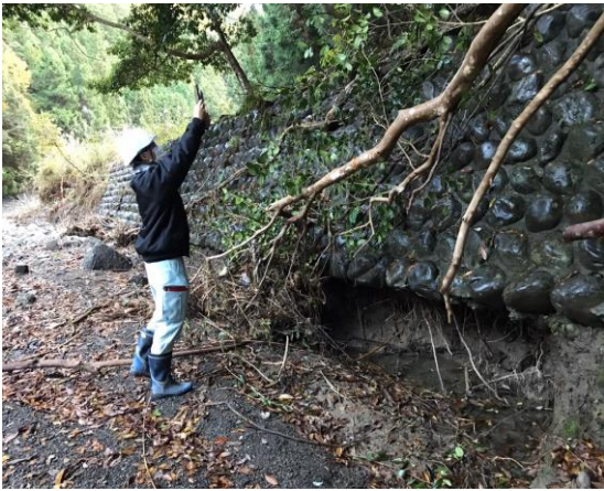
職員によるタブレット端末での点群計測 (計測時間:5~10分程度)
