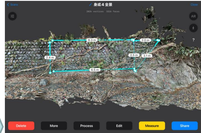
取壊し数量等をデータ上で確認
