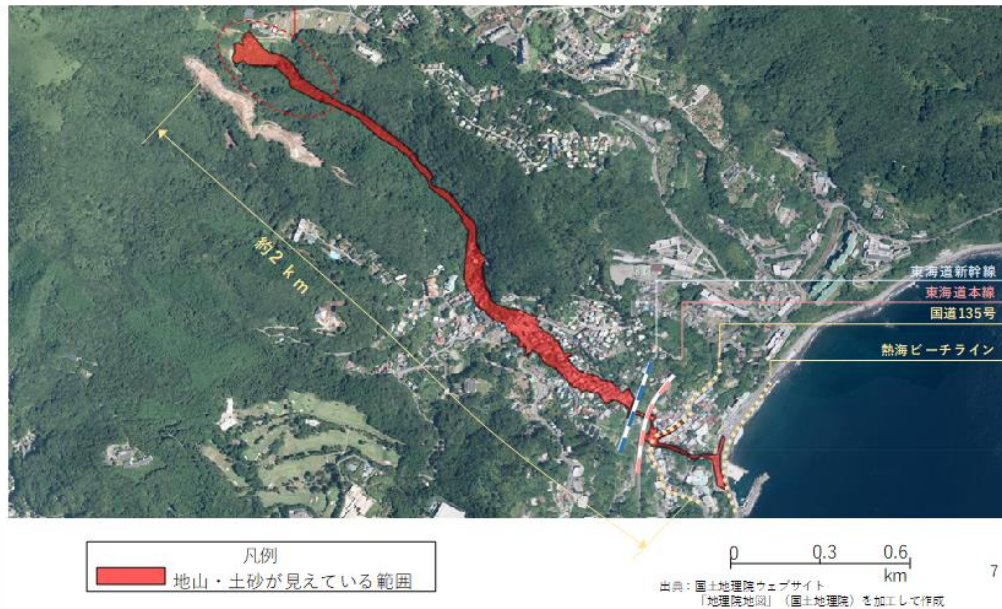
図4 崩落及び土石流被害範囲位置図
